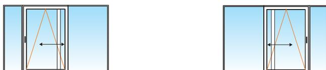
Veuillez noter que la largeur d'une fenêtre ne doit pas dépasser 2/3 de sa hauteur. Pour des conditions de largeur / hauteur supérieures, cela peut être dû au levier de Les terminaux de l'aile viennent. Dans ce cas, nous ne garantissons pas. Nous recommandons plutôt de choisir une fenêtre à 2 feuilles.
